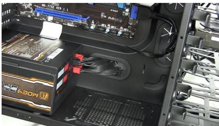
Рисунок 4 - Монтаж блока питания
