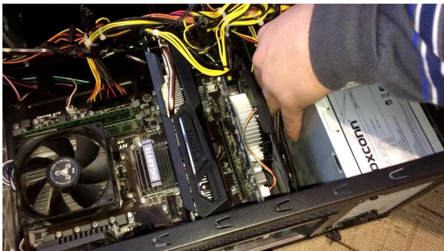
Рисунок 12.9 – Установка видеокарты
