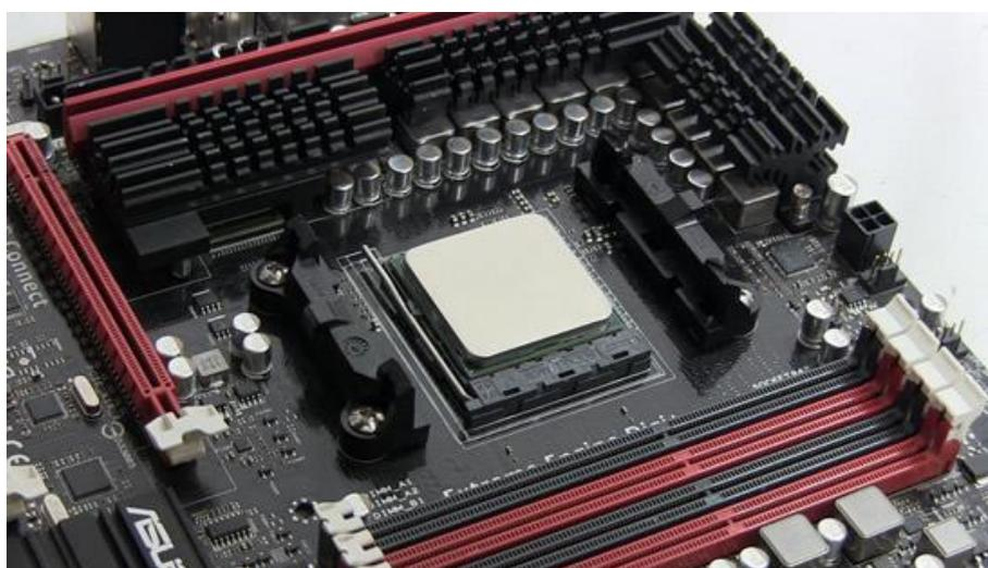
Рисунок 6 - Установка процессора Intel (шаг 2)
