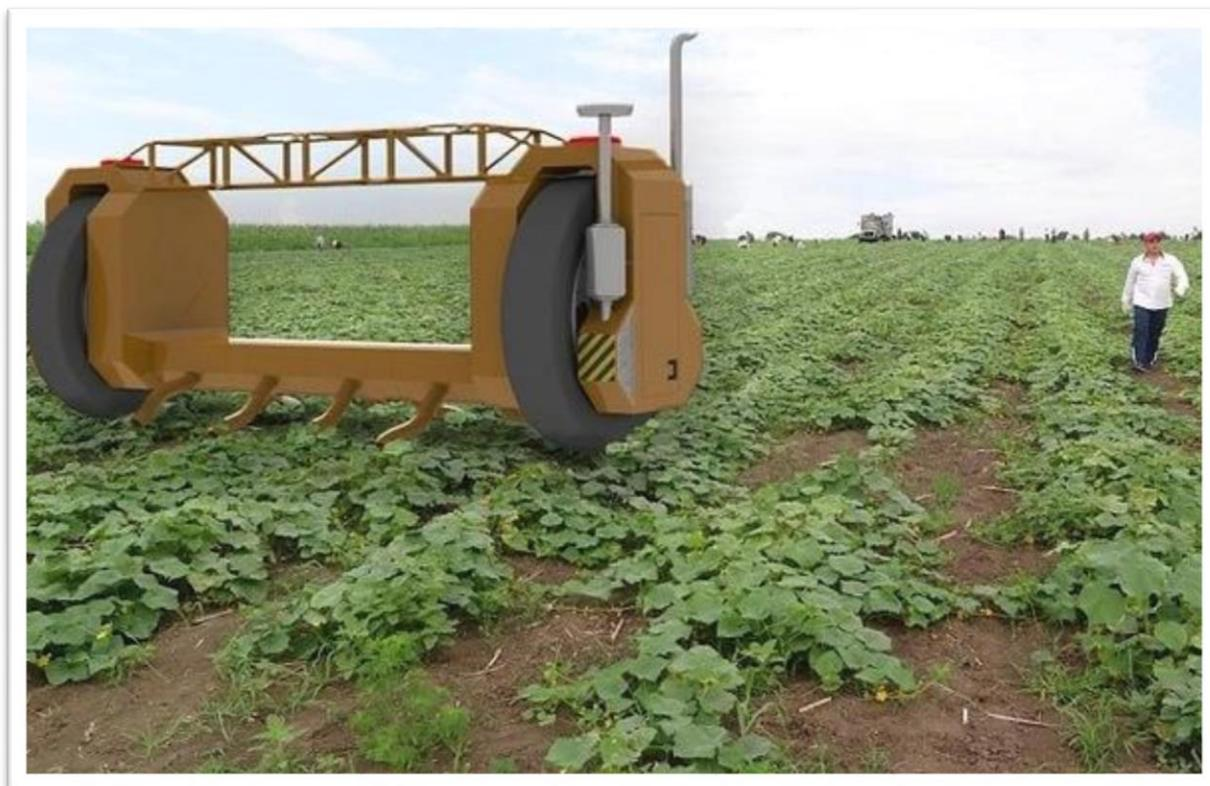
Робот самостоятельно двигается по полю с огурцами и при помощи рук-манипуляторов собирает зеленцы в специально оборудованные емкости. Когда все емкости будут заполнены, машина сама выгрузит овощи и продолжит все заново. Называется такая чудо-машина «Робот-комбайн «Гранат».
