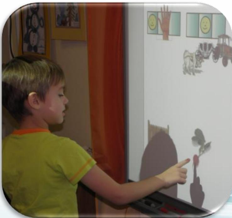
**Интерактивная доска - это устройство, использующееся с проектором и компьютером. Изображение с компьютера выводится на интерактивную доску, как на обычный экран, с помощью проектора. Используя маркер или палец, можно не отходя от доски управлять компьютерными приложениями или делать пометки поверх изображения.**
