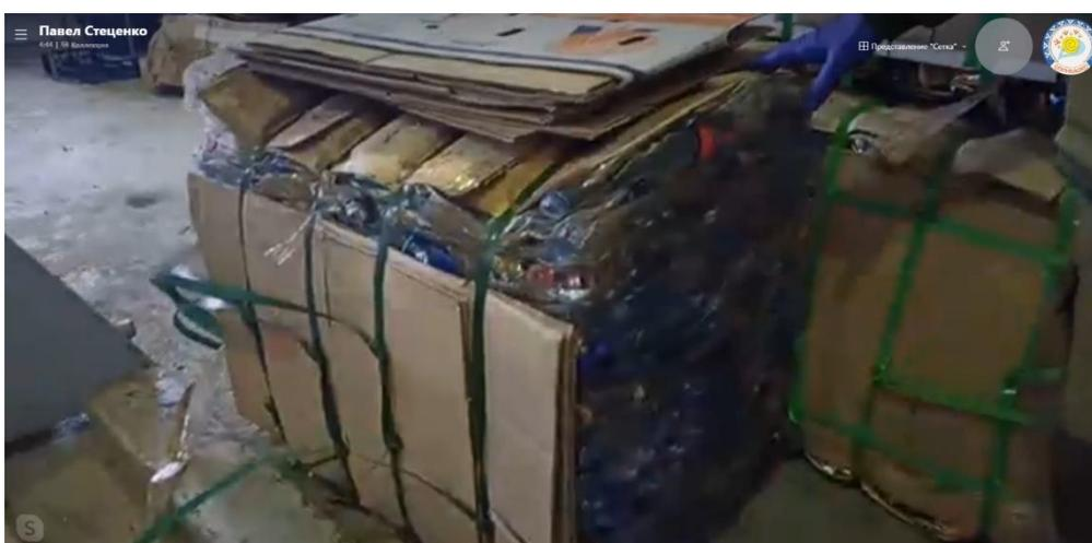
кубических метра и весом 70-110 килограмм. Бумага 6-7 кубических метров сжимается до 0,3 кубических метра и весом до 180 килограмм. Все эти работы производятся для уменьшения объёма и удобства дальнейшей транспортировки.
